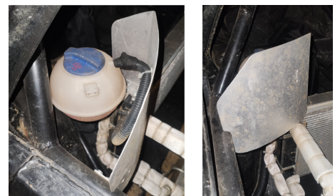
Minimalster Spritzschutz für Ausgleichsbehälter (mehr ist empfohlen)
